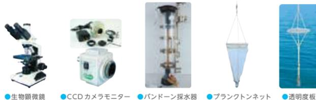
●生物顕微鏡 ●CCDカメラモニター ●バンドーン採水器 ●プランクトンネット ●透明度板
