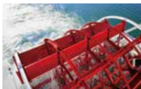
密西根號是難得一見的透過後方輪槳推動行駛的船隻。遊客可透過船內的輪槳觀賞區，從正上方觀賞輪槳的運轉方式。
